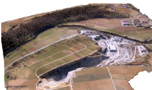
Rys. 4. DEM i ortofotomapa wygenerowane na podstawie zobrażeń UAV (56 zdjęć, rozdzielczość 4K × 3K) (Haala et al. , 2011)
