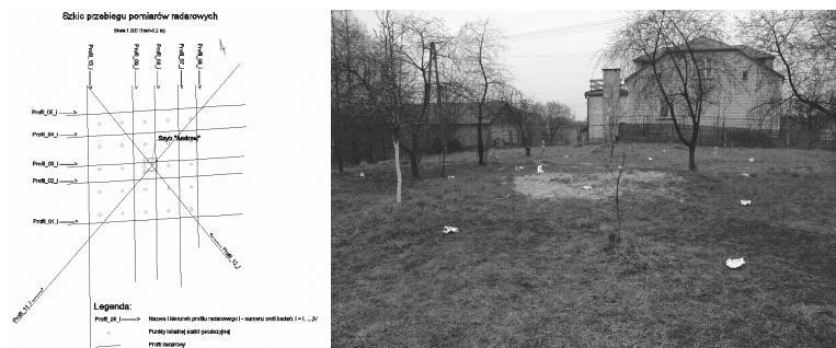
Rys. 1. Szkic rozmieszczenia profili georadarowych względem lokalizacji szyby oraz fotografia obszaru testowego.
