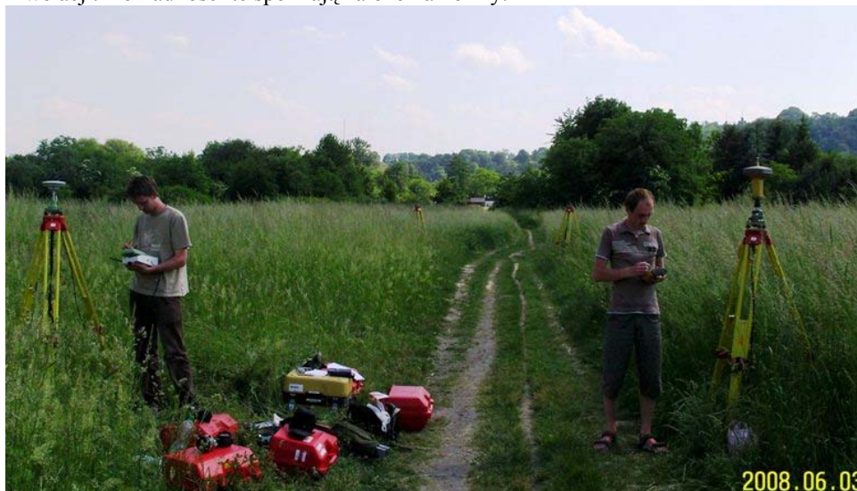
Rys. 2. Test odbiorników Leica GX1230 i Topcon GR-3
