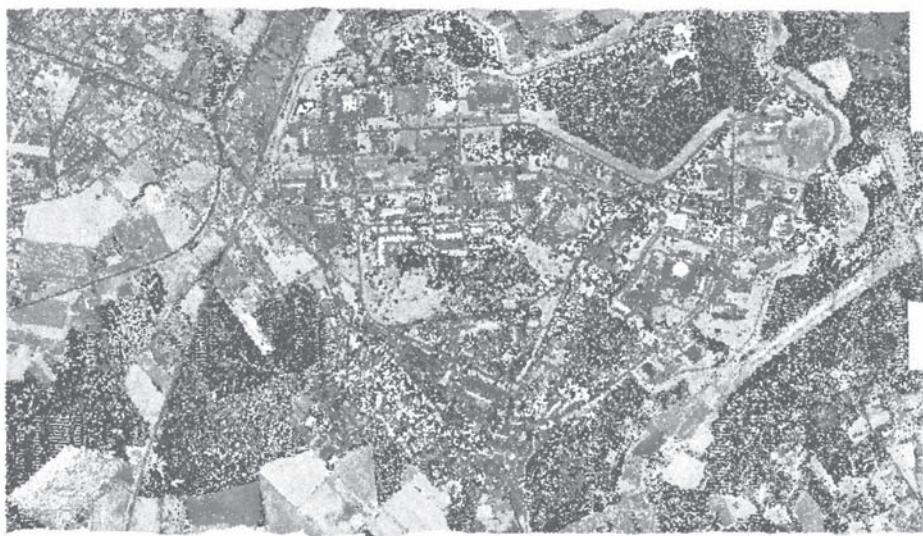
Rys. 2. Chmura punktów ALS wyświetlana wg wartości parametru intensywności odbicia.
