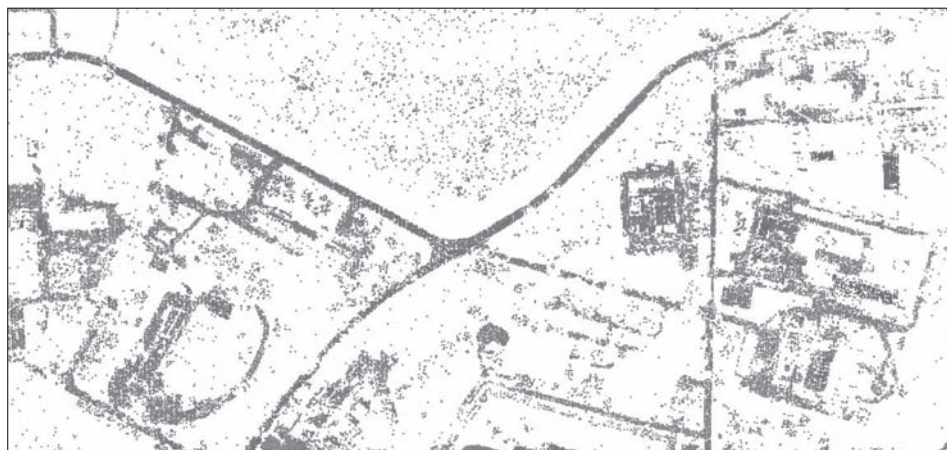
Rys. 4. Zbiór D – wybrany fragment chmury punktów przed filtracją.
