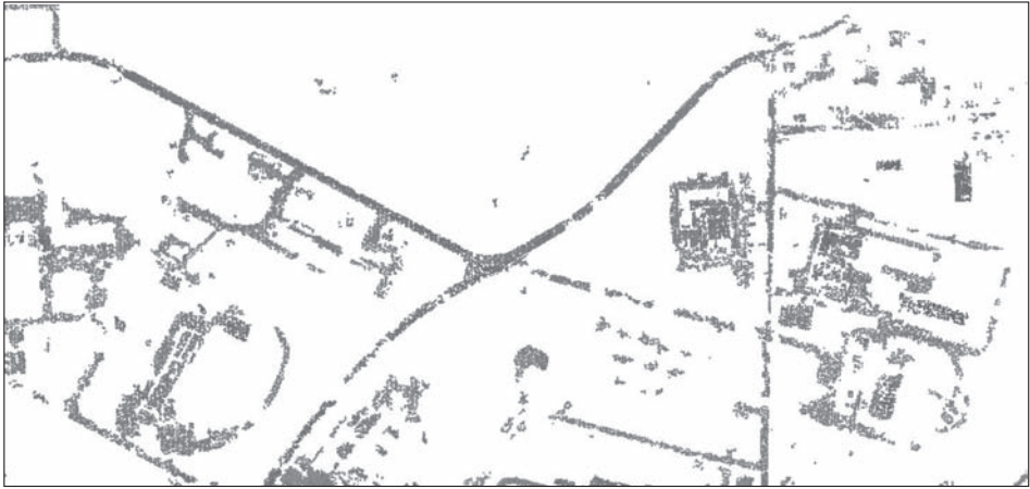
Rys. 5. Zbiór D – wybrany fragment chmury punktów po filtracji.
