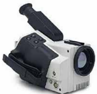
Rys. 2. Kamera termalna ThermaCam PM575
