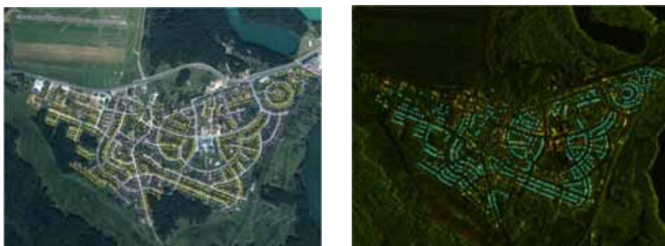
Rys. 6. Zdjęcia Ikonos i TerraSAR-X z „nakładką budynków”
