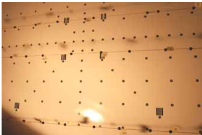
Rys.4. Pole testowe do kalibracji aparatu fotograficznego
