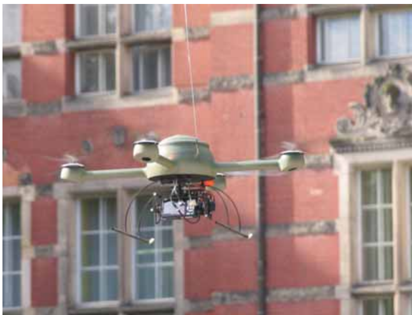
Rys.1. Zdjęcie mini śmigłowca MD4-200 z aparatem cyfrowym Pentax Optio A40
