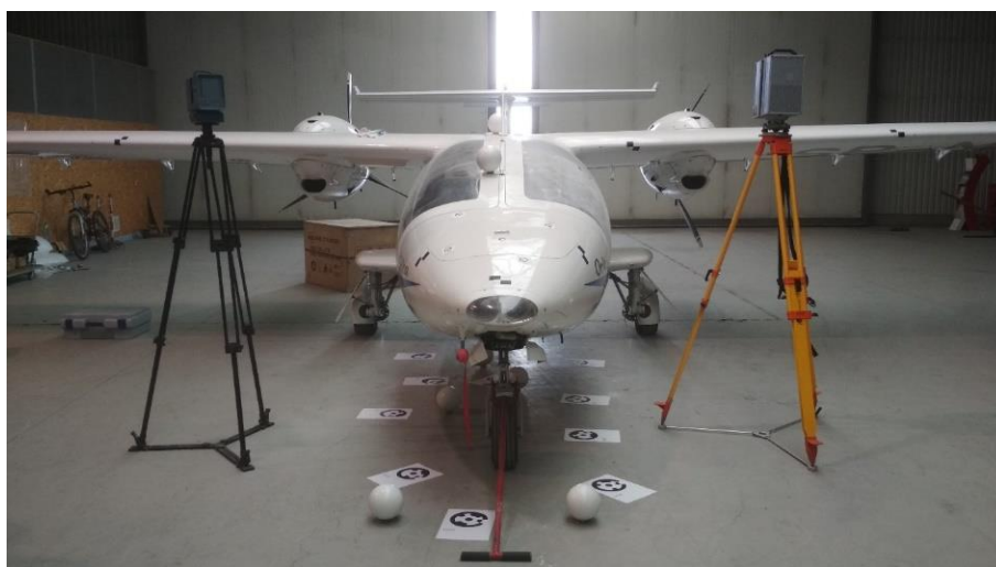
Rys.4. Rozmieszczenie skanerów w trakcie pomiaru
