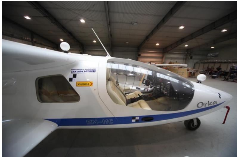
Rys.1. Rysunek poglądowy rozmieszczenia tarcz i kul fotogrametrycznych
