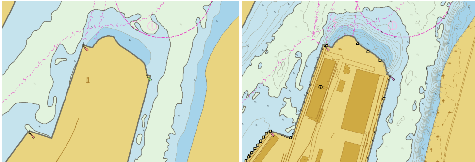
Rys. 5. Fragment typowej mapy Standardu S-57 (po lewej) oraz precyzyjnej elektronicznej mapy nawigacyjnej (po prawej)
