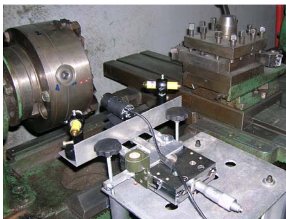
Rys. 7. Profilograf optoelektroniczny podczas badania kołowości wrzeciona tokarki
