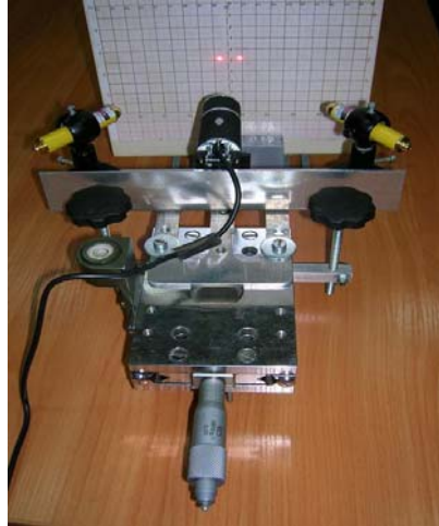
Rys. 5. Prototyp profilografu laserowego podczas kalibracji
