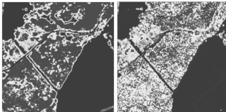
Rys. 1. Wizualizacja danych opisujących wysokości elementów pokrycia terenu: model różnicowy pomiędzy NMPT i NMT (po lewej) i wariancja wysokości punktów pomiarowych (po prawej stronie).
