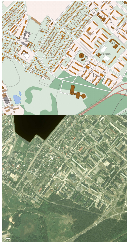
Rys. 1. Przykłady modelu kartograficznego i obrazowego (powyżej: fragment wizualizacji treści komponentu TOPO TBD w skali 1:10000; poniżej: fragment ortofotomapy tego samego obszaru)
