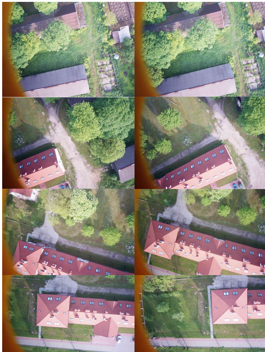
Rys.3. Przykładowe zdjęcia otrzymane w wyniku realizacji lotu fotogrametrycznego – dwie ostatnie stereopary opracowano niezależnie na VSD-AGH .
