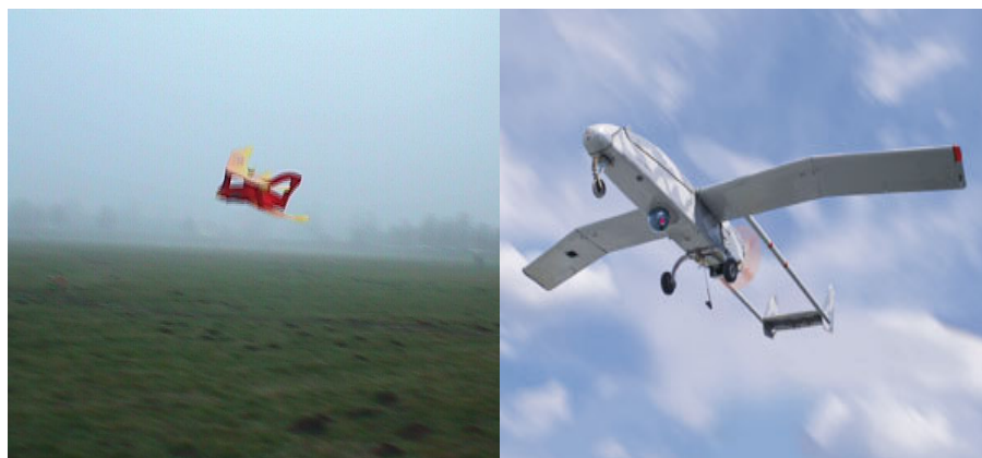
Rys.1. Przykłady rozważanych dla zastosowań fotogrametrycznych bezzałogowych platform lotniczych – BŚL (z lewej jeden z amatorskich samolotów z napędem elektrycznym, testowany przez autora do przedmiotowych badań, po prawej - amerykański SHADOW 600 o rozpiętości 5.8 m, z widoczną na zdjęciu kamerą)
