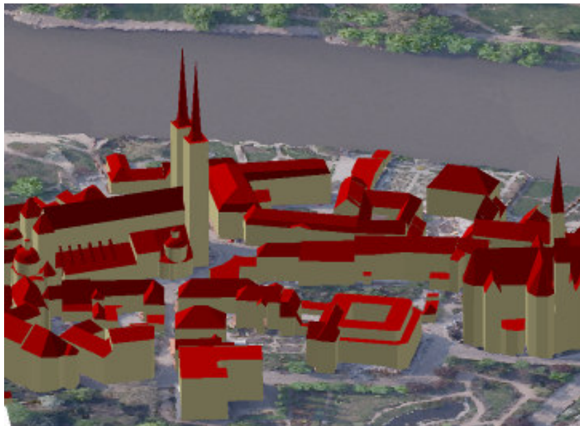
Rys. 5. Model 3D miasta utworzony z danych LIDAR
