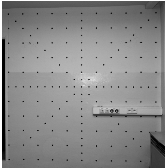
Rys. 1. Pole testowe wykorzystane do sprawdzenia wpływu dystorsji
