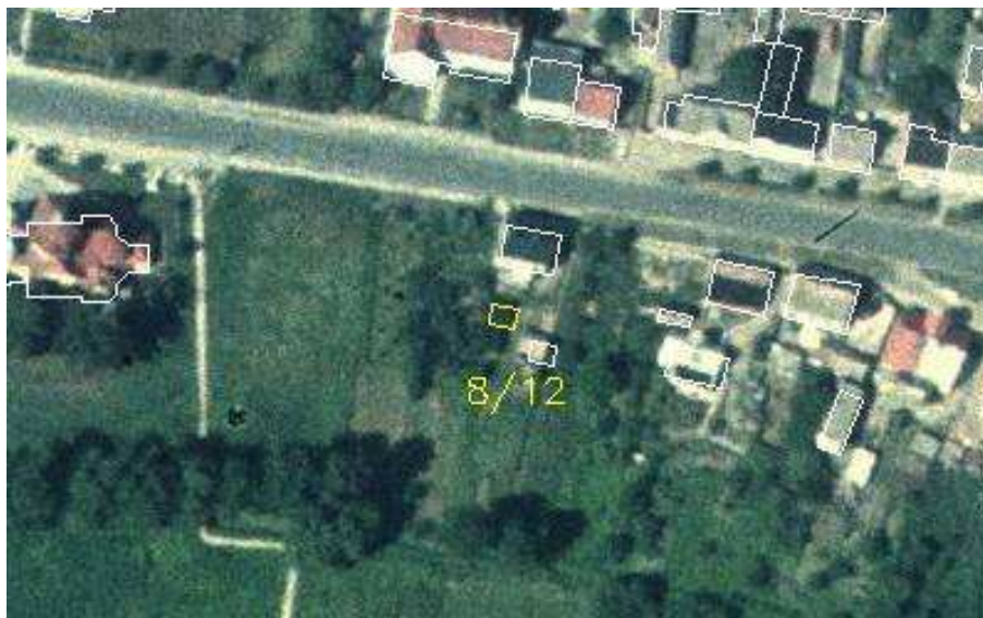
Rys. 6b. Przykłady miejsc wskazanych przez system jako elementy usunięte – błąd spowodowany zasłonięciem przez konary drzewa
