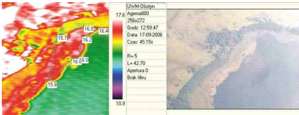
Rys. 12. Drugi lotniczy termogram z szeregu z zaznaczonym analizowanym obszarem i jego cyfrowy obraz wizyjny
