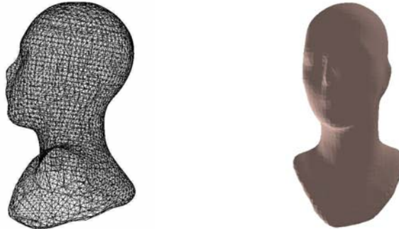
Rys. 5. Wizualizacja modelu manekina w postaci siatki trójkątów i metody cieniowej
