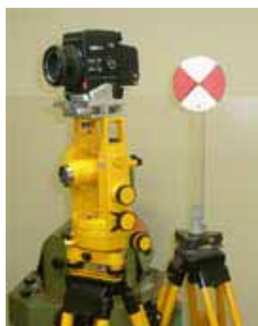
Rys. 3a. Fototeodolit w ustawieniu do zdjęcia poziomego
