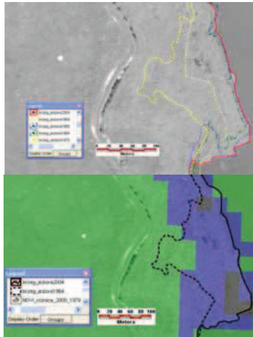
Rys. 7. Akumulacja brzegowa widoczna na ortofotomapach z lat a) 1964 (kolor żółty – linia brzegowa a roku 1964, kolor czerwony – z roku 2004) i b) 2004 (linia przerywana – 1964, linia ciągła – 2004)
