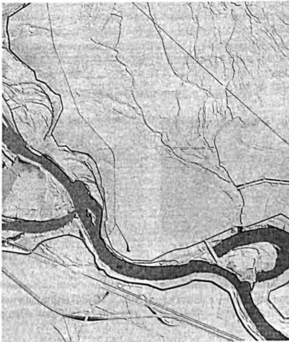
Rys. 3. Przykład DTM uzyskanego z pomiaru LiDAR (TMCE)
