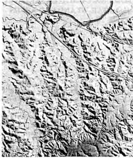
Rys. 1. Przykład DTM uzyskanego z pomiaru LiDAR (TMCE)
