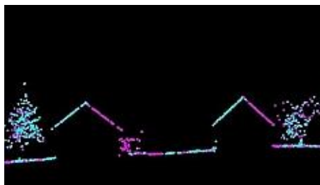
Rys. 14. Punkty pozostawione w wyniku odfiltrowania punktów overlap w badanym algorytmie: punkty seledynowe - punkty szeregu lewego, punkty różowe - punkty szeregu prawego
