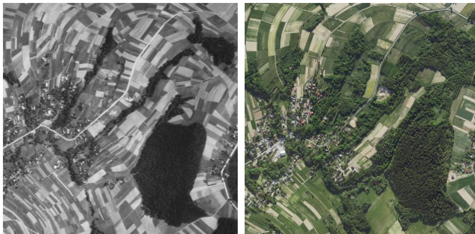
Rys. 1 Archiwalne zdjęcia Polski – miejscowość Harta (woj. podkarpackie). Po lewej stronie fragment zdjęcia analogowego z 1965 r., skala 1:19 000, średni rozmiar piksela 20 cm. Po prawej stronie – fragment zdjęcia z 2022 r., GSD 25 cm.
