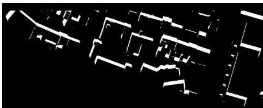
Rys. 3.2. Prezentacja graficzna martwych pól na cyfrowej ortofotomapie spowodowana zabudową mieszkaniową
