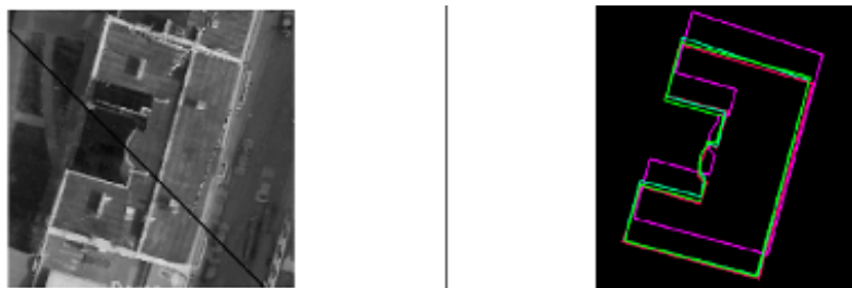
Rys. 5.3. Przykładowy rezultat wektoryzacji obrysu dachu budynku na trueortho i tradycyjnej ortografii
