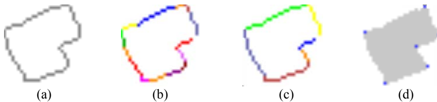
Rys. 3. Detekcja naroży budynku – segmentacja linii. Punkty konturu (a), identyfikacja odcinków prostych (b), łączenie linii (c), punkty narożne (d)
