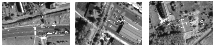
Rys. 1. Projekt punktów osnowy fotogrametrycznej na obrazach Resurs-DK
