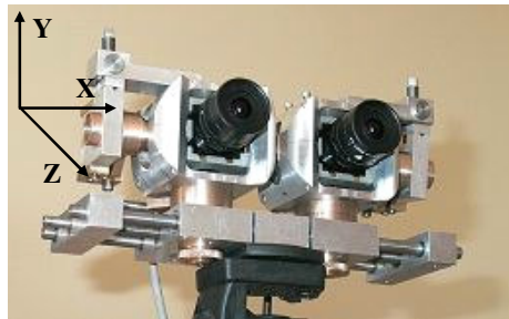
Rys. 2. Kamery cyfrowe Flea® umieszczone w głowicy mechanicznej (baza)
