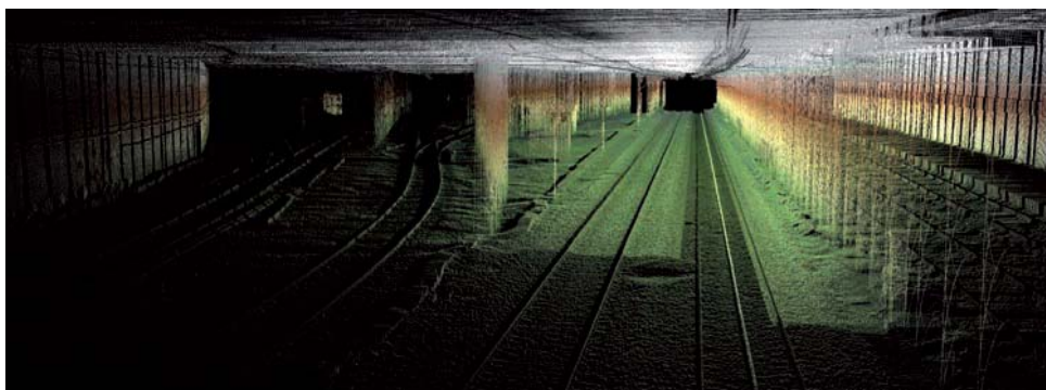
Rys. 1. Widok chmury punktów w tunelu średnicowym (Gispro Sp. z o.o.)
