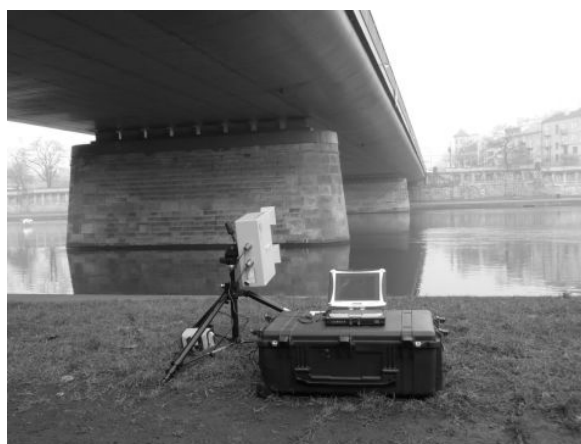
Rys. 1. System IBIS-S pod Mostem Powstańców Śląskich w Krakowie
