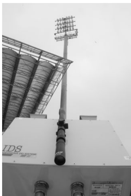
Rys. 3. Widok sceny oświetlanej przez radar IBIS-S
