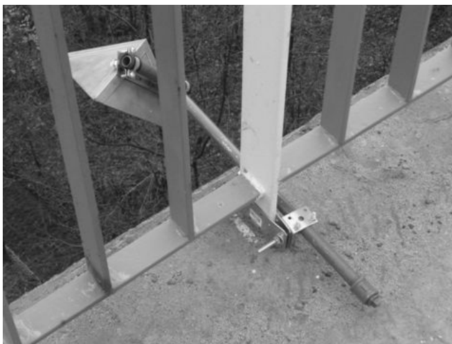
Rys. 23. Sposób zamocowania reflektora mikrofal
