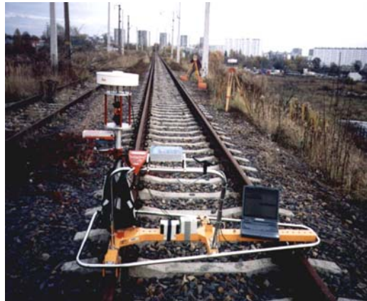
Rys. 3. Wózek pomiarowy zbudowany w AGH na bazie toromierza elektronicznego
