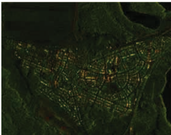
Rys. 7. Kompozycja barwna złożona z obrazu HH i VV odpowiednio jako komponenty R i G (komponent B wynosi zero). Zmienność barw wskazuje na nieco odmienne rozpraszanie w obu komponentach polaryzacji
