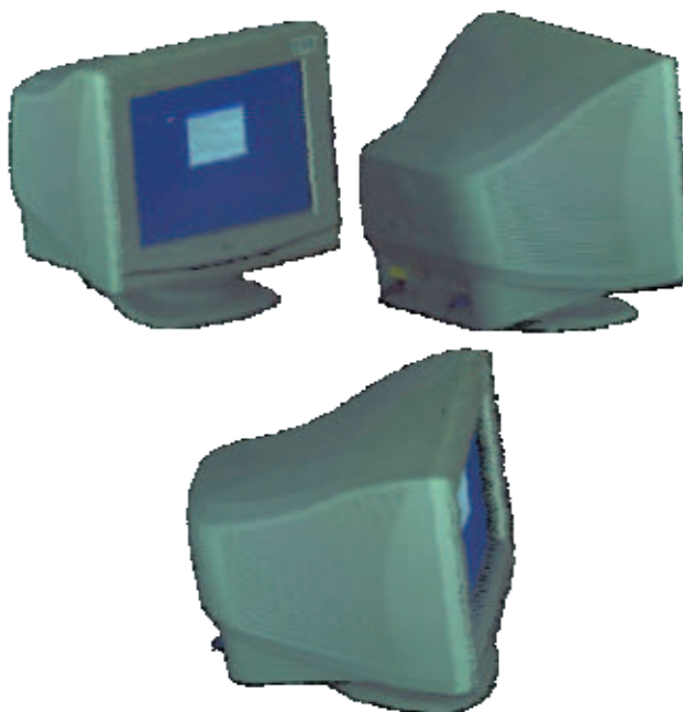
Rys. 1. Model 3D obiektu w postaci chmury punktów z rozdzielczością 1 mm z teksturą z wbudowanego w skaner aparatu cyfrowego
