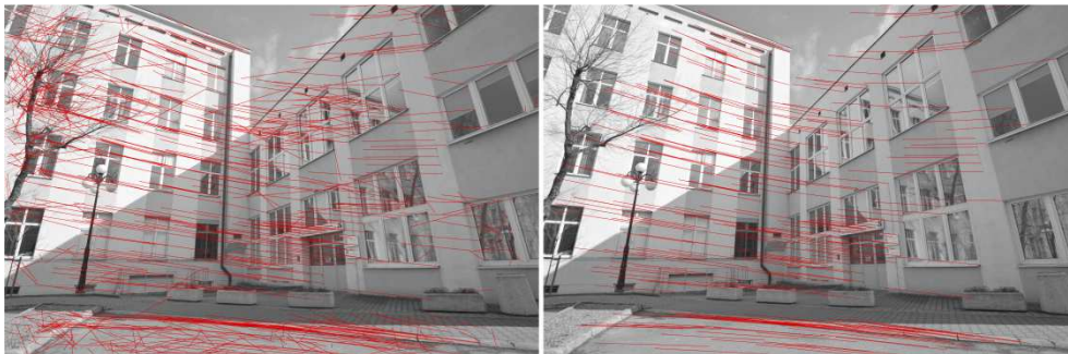
Rys. 1. Efekt działania algorytmu RANSAC. Odcinki łączą położenie punktu wiążącego na zamieszczonym oraz na kolejnym zdjęciu. Po lewej: efekt pomiaru automatycznego, po prawej: sytuacja po orientacji wzajemnej (Kolecki, 2015).
