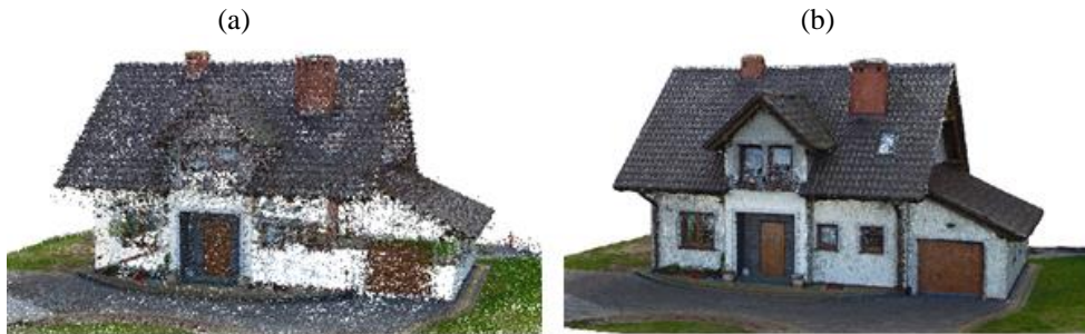
Rys. 4. „Rzadka” chmura punktów (a) oraz „gęsta” chmura punktów (b) badanego obiektu
