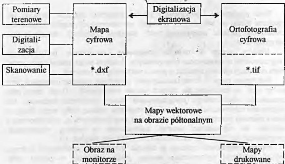
Rys. 1. Schemat sporządzania podkładów dla celów projektowych w postaci cyfrowych map wektorowych na obrazie półtonalnym.
