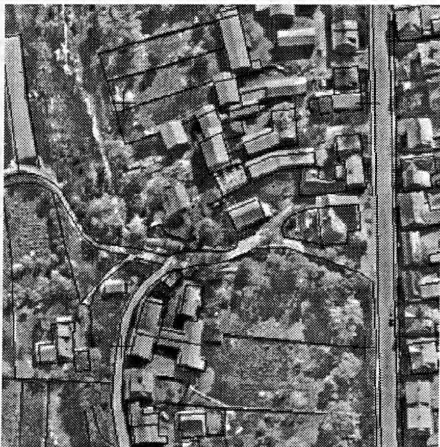
Rys. 7 Przykład połączenia ortofotografii cyfrowej ze zdjęć wielkoskalowych z mapą wektorową obszaru zabudowanego.
