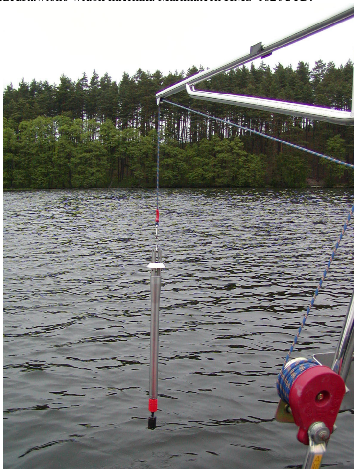
Rys. 3. Pomiar prędkości dźwięku w wodzie z wykorzystaniem miernika HMS-1820CTD Fig. 3. Measurement of the sound speed in water using the profiler Marimatech HMS 1820CTD
