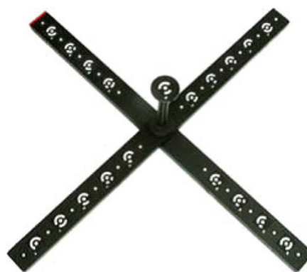
Rys. 10. Krzyż do kalibracji
