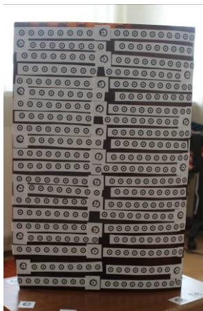
Rys. 6. Naniesione na obiekt punkty do pomiaru
